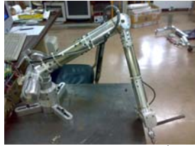
รูปที่ 12 เครื่องวัดพิกัด 3 มิติ ซียู-ซีเอ็มเอ็ม ที่ได้มีการดัดแปลงแล้ว
