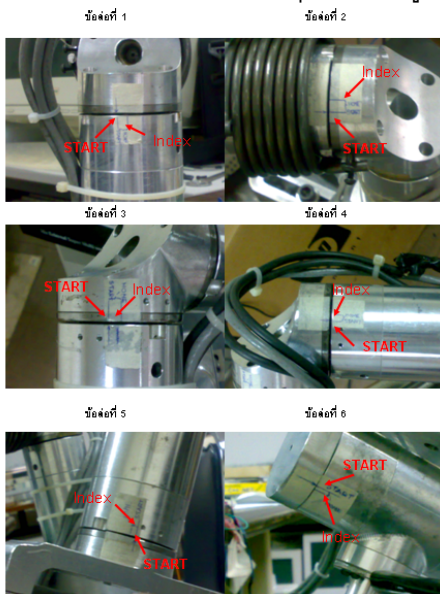
รูปที่ 16 ตำแหน่งเริ่มต้นและขอบเขตของการหาอินเดคของทั้ง 6 ข้อต่อ
