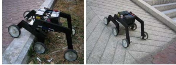
รูปที่ 8 หุ่นยนต์ต้นแบบเคลื่อนที่ผ่านอุปสรรค ที่ลักษณะเป็นขั้น และทางลาดชัน
