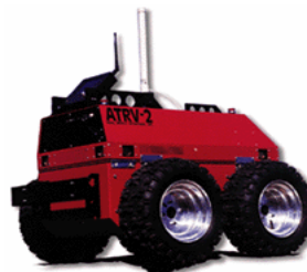
รูปที่ 1 หุ่นยนต์ ATRV2, การเคลื่อนที่โดยอาศัยล้อ [1]
