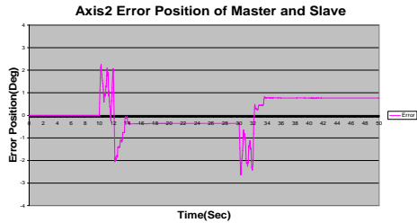
รูปที่ 15 ค่าความผิดพลาดของข้อต่อที่ 1 ที่มีตัวหน่วงเวลา โดยใช้ตัวแปรคลื่น
